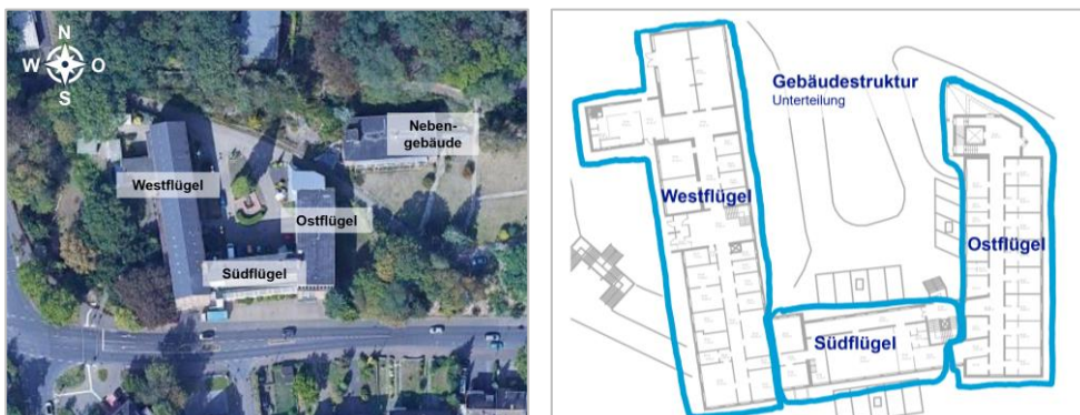
Abbildung 28: Unterteilung der Gebäudestruktur
